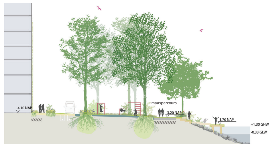
Doorsnede van de promenade
